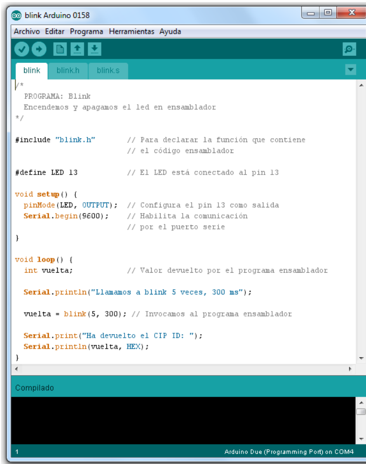
Figura 9.11: Entorno Arduino con el programa «blink» cargado
