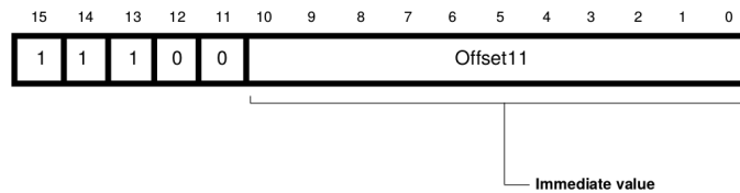
Figura 4.10: Formato de instrucción utilizado para codificar la instrucción « b etiqueta»
