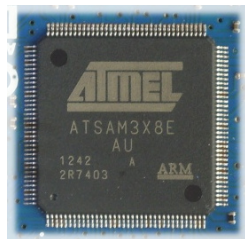
Microcontrolador ATSAM3X8E ARM Cortex-M3 144 pines (103 pines GPIO)
