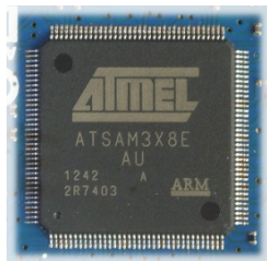
Microcontrolador ATSAM3X8E ARM Cortex-M3 144 pines (103 pines GPIO)
